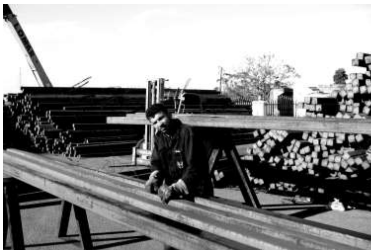
الشكل (13) - التحضيرات الأولية للبيليت قبل إجراء الفحص بالأمواج فوق الصوتية
