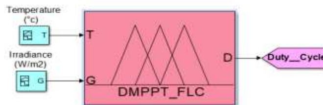
الشكل (9) النموذج النهائي للمتحكم العائم المقترح DMPPT-FLC المطور باستخدام Fuzzy Logic Toolbox
