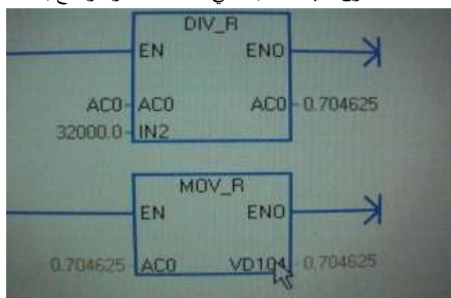
الشكل (7) مقطع من برنامج PLC يبين ضبط النقطة المرجعية.
