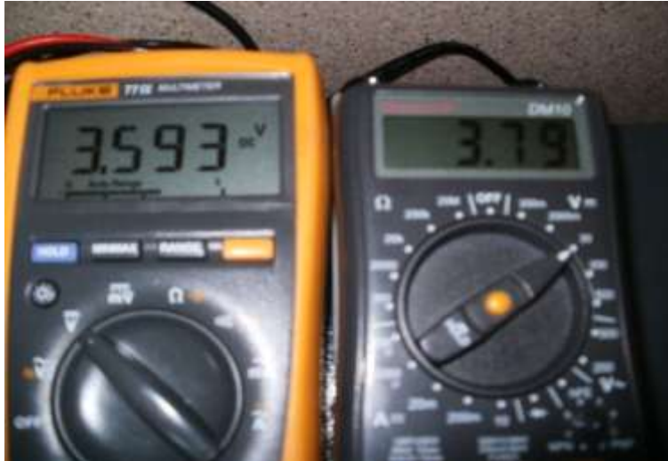
الشكل (10) قراءة مقياسي الجهد لإشارة جهاز التدفق وإشارة التحكم.
