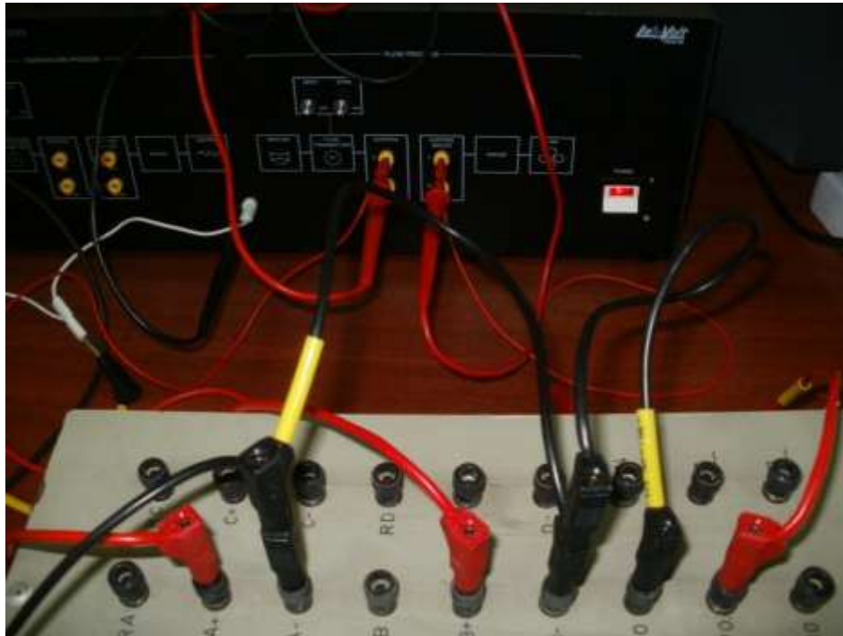
الشكل (6) مخطط توصيل مخارج ومداخل التوسعة التشابيهية لجهاز التدفق.
