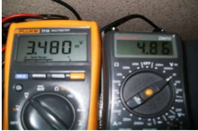
الشكل (11) قراءة مقياسي الجهد لإشارة جهاز التدفق وإشارة التحكم عند فتح الخانق وتخلخل الضغط.
