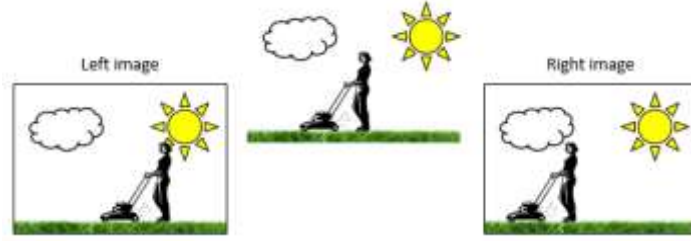
الشكل (1) مبدأ الصور المجسمة ،التقاط صورتين لنفس المشهد بواسطة كاميرتين تفصل بينهما مسافة أفقية صغيرة
