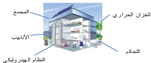
شكل 11: العناصر والتجهيزات المستخدمة في نظام الطاقة الشمسية المستخدم لتسخين الماء الصحي والتدفئة
