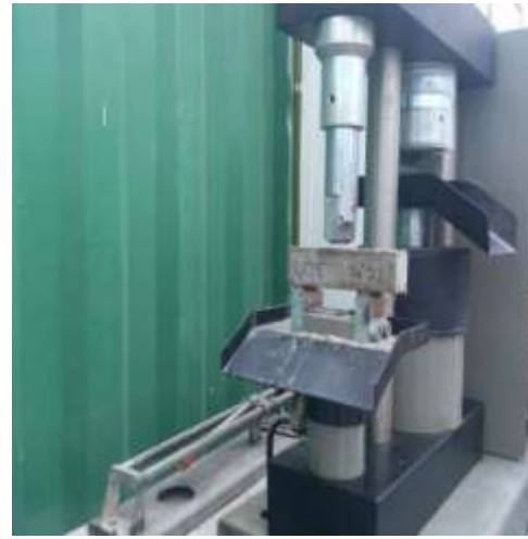
الشكل(4) المواشير المدعمة بألياف البولي بروبيلين بعد الكسر
