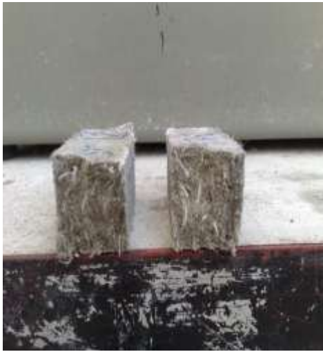
الشكل(4) المواشير المدعمة بألياف البولي بروبيلين بعد الكسر
