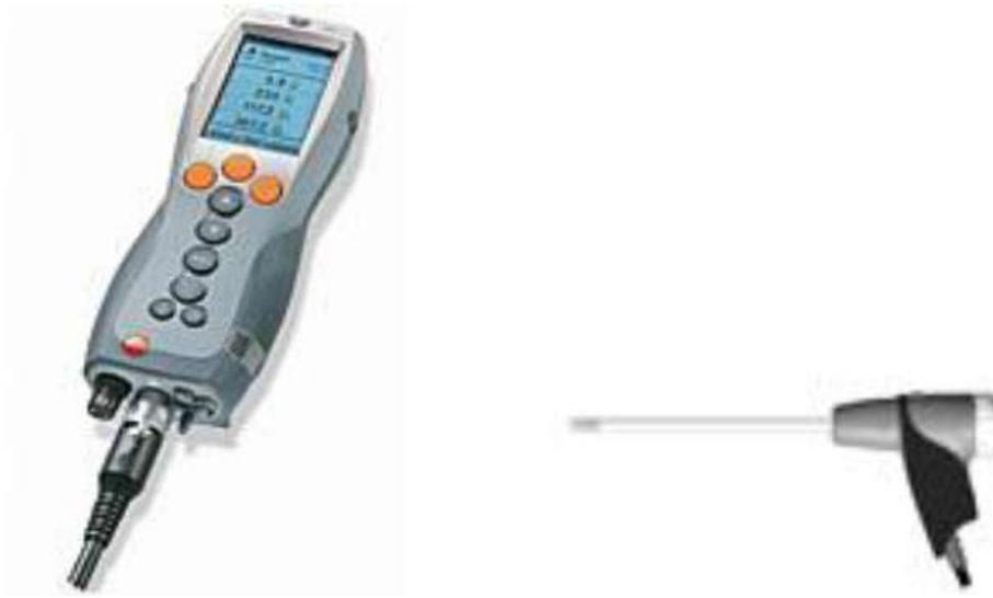
الصورة(2) جهاز قياس تراكيز غازات العادم testo 350
