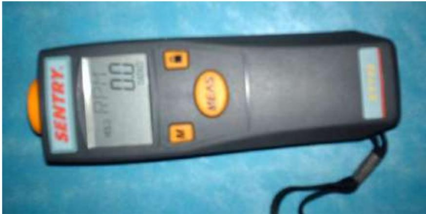
صورة(3) جهاز قياس سرعة الدوران
