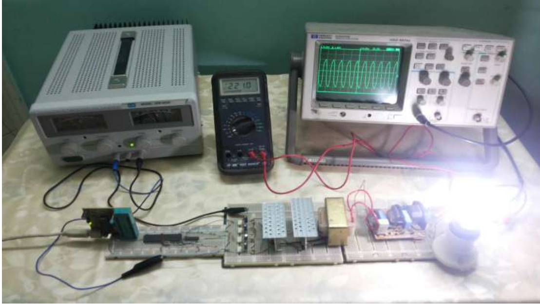
الشكل (8): دائرة الاختبار العملية من أجل حمل أومي.
