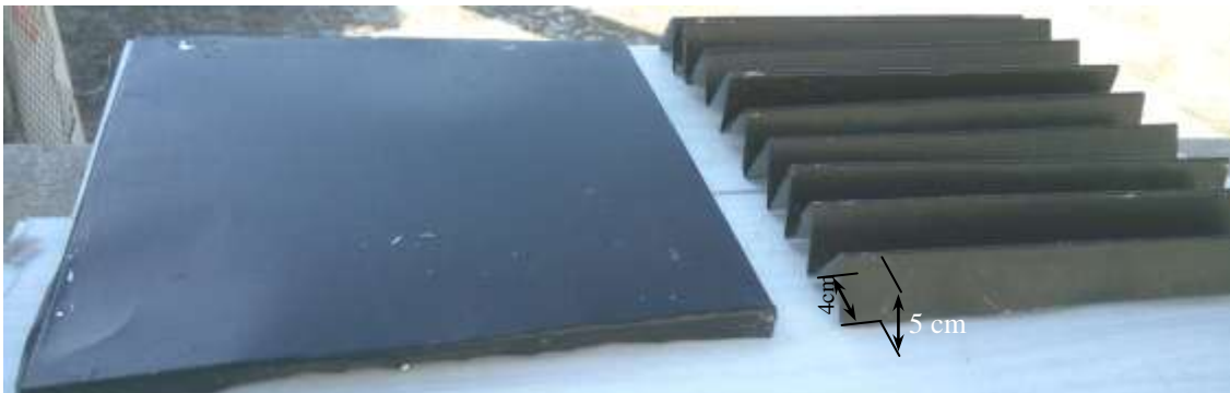
الشكل (2) الصفيحة الماصة المستوية والمنكسرة على شكل حرف V المستخدمة في التجربة
