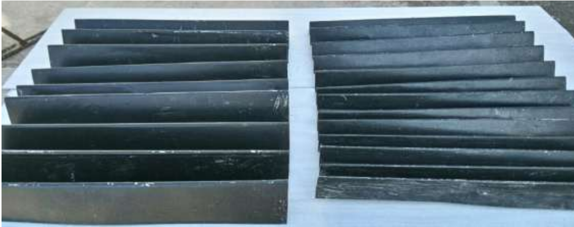
الشكل (8) الصفيحتين الماصتين المنكسرتين المستخدمتين في التجارب بأبعاد موجة مختلفة
