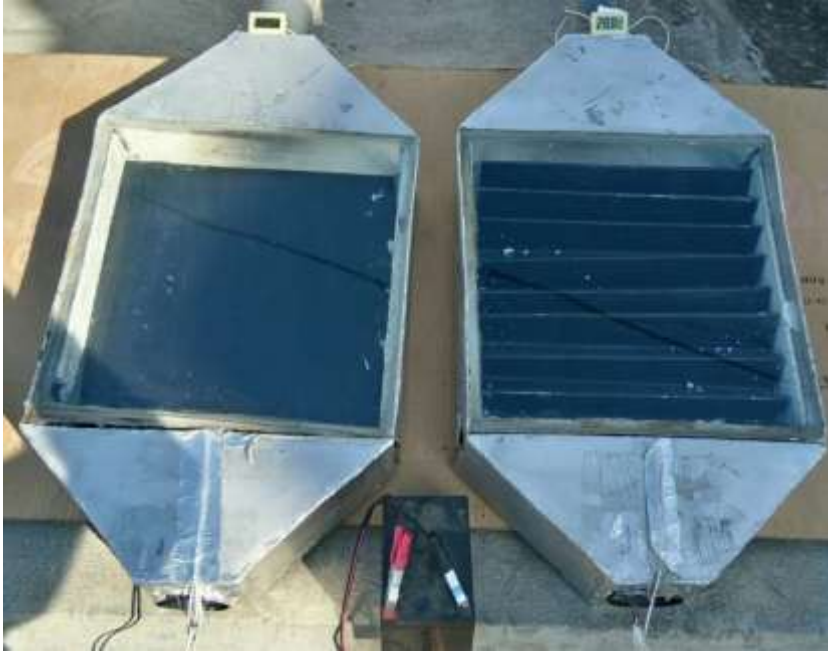
الشكل (1) اللاقطين الشمسيين الهوائيين مع مكان توضع مقاييس درجات الحرارة
