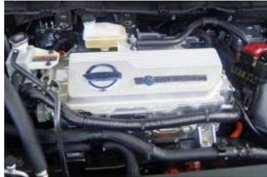
الشكل (4): المحرك الكهربائي المستخدم في سيارة نيسان ليف الكهربائية.
