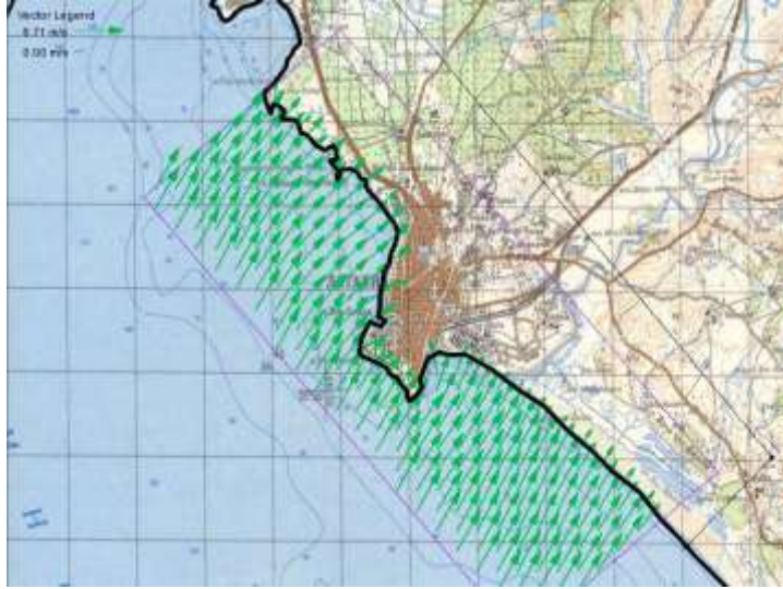
شكل (13). اتجاه الأمواج وقيمها المتشكلة في المنطقة ( H_s=6.4m , T_p=10sec , Direction: WSW).
