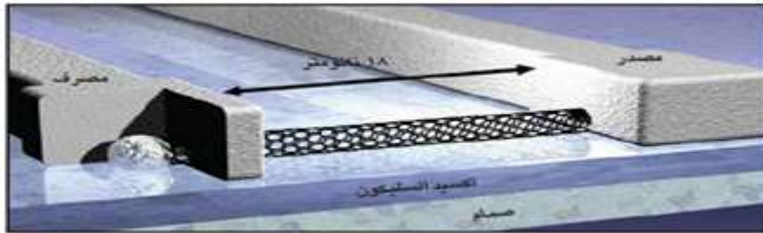
الشكل (14) تصنيع الترانزستور بواسطة أنابيب الكربون النانوية.
