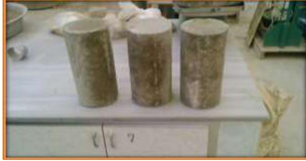
الشكل 6 عينات الـ RCC المرصوصة بطريقة مارشال
