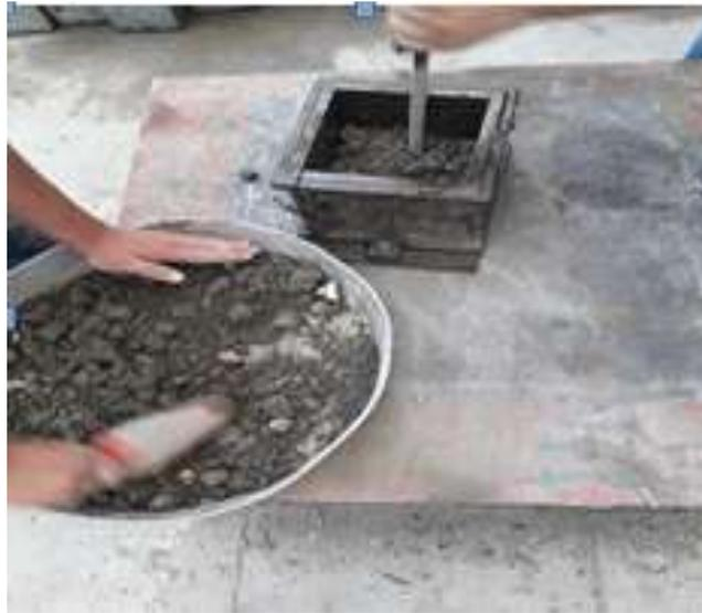
الشكل 7 إملاء مكعبات الـ RCC أثناء وضعها على الطاولة الرجاجة
