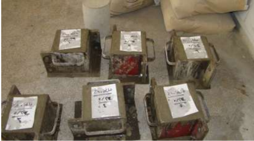
الشكل (1) بعض العينات البيتونية المكعبية المصبوبة في مخابر جامعة دمشق وفق نسب خلط مختلفة
