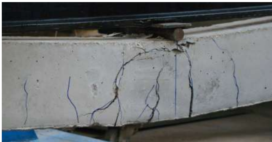
الشكل (9) اختبار مقاومة الانعطاف للجوائز البيتونية المسلحة
