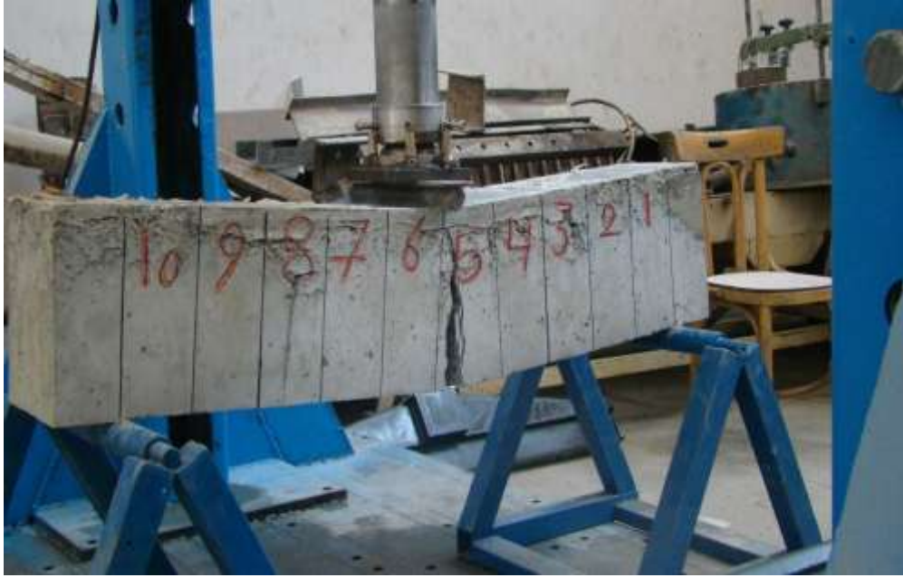
الشكل (15) اختبار معامل التشقق للجوائز البيتونية المسلحة (بازلت 100%) وطريقة توزيع الشرائح
