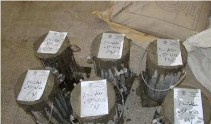
الشكل (2) بعض العينات البيتونية الاسطوانية المصبوبة في مخابر جامعة دمشق وفق نسب خلط مختلفة
