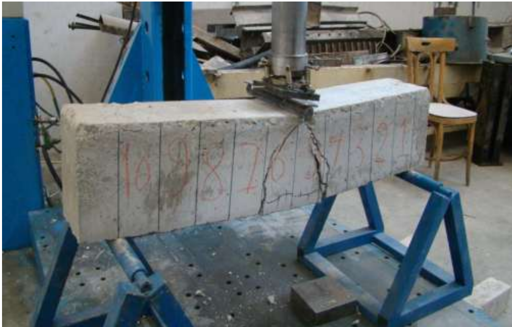
الشكل (16) اختبار معامل التشقق للجوائز البيتونية المسلحة (كلسي 100%) وطريقة توزيع الشرائح
