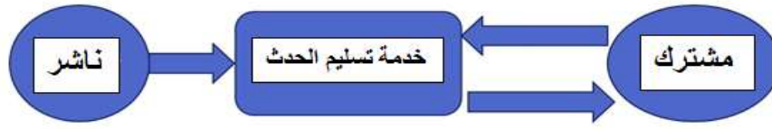
الشكل (1) بنية بسيطة لنظام نشر و اشتراك
