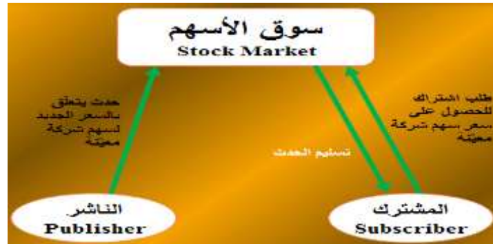
الشكل (2) بنية بسيطة لنظام نشر و اشتراك
