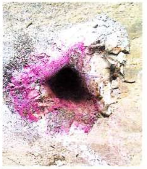
نموذج لقياس عمق التآكل في الركانر
