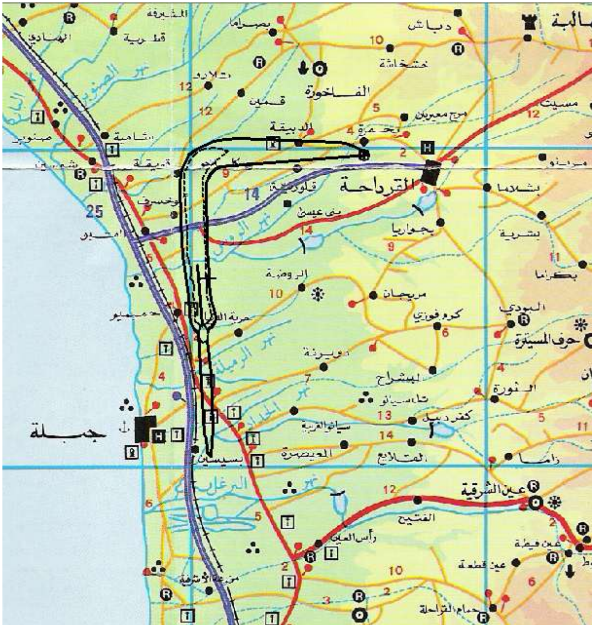
الشكل (3): مناطق تأثير الضجيج الجوي للطائرات حسب مستوى الصوت المكافئ من أجل مطار الشهيد باسل الأسد. ( — 55 ديسبل ليلاً، - - - 65 ديسبل نهاراً، — المهبط )
