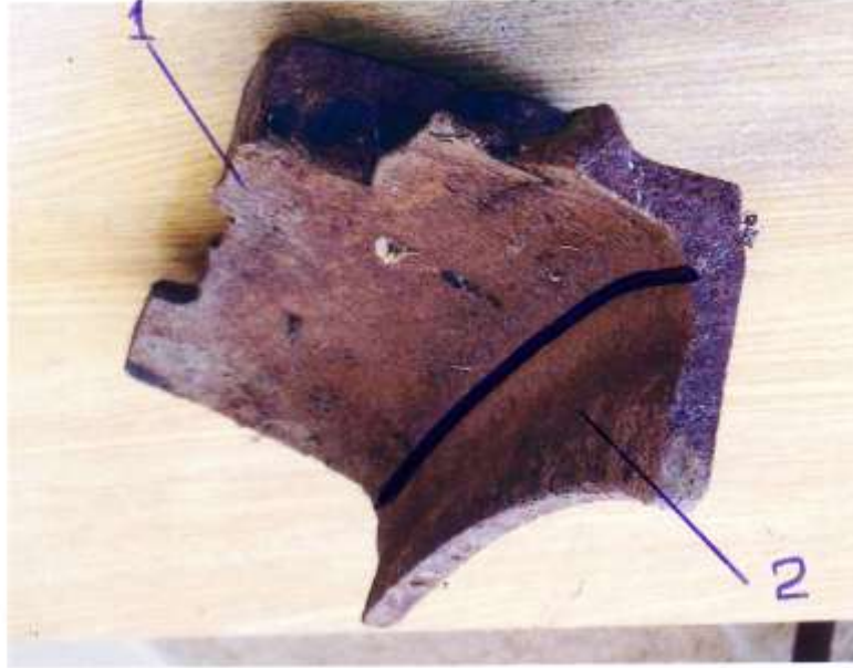
الشكل ( 4 ) صورة لإحدى نعلات اللجام التي تآكلت بسبب الحركة العرضانية على محيط العجلة .
