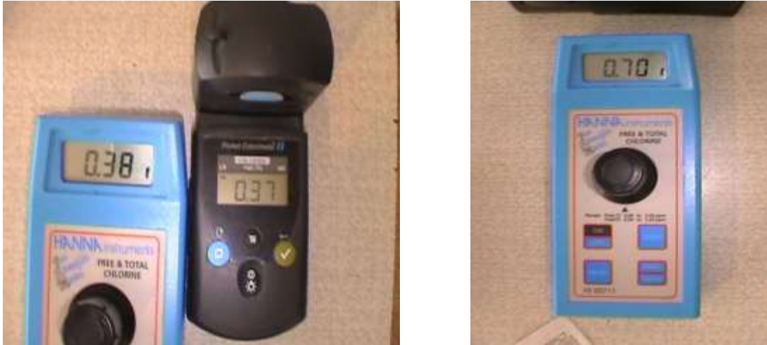
الشكل (1): الأجهزة المستخدمة لقياس نسبة الكلور الحر في مياه الشرب
