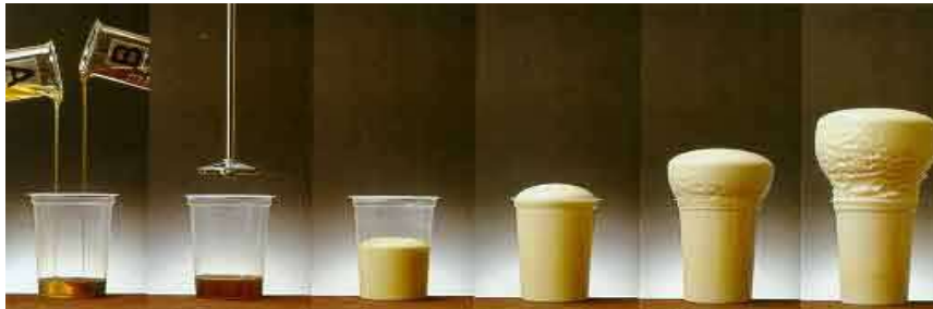
الشكل (2) - تشكل ونمو الرغوة في وسط مفتوح منذ لحظة المزج الأولى حتى الحصول على المنتج النهائي
