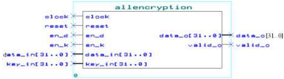
الشكل (17) الرمز التخطيطي للدائرة المصممة باستخدام لغة التصميم VHDL وبيئة التصميم MAX+PLUS II
