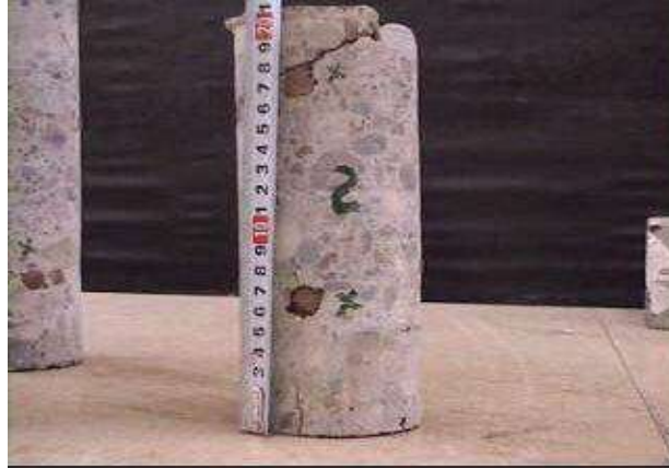
الشكل رقم (7): ارتفاع طبقة الحماية الخرسانية في مواقع أخرى بمقدار 7 cm
