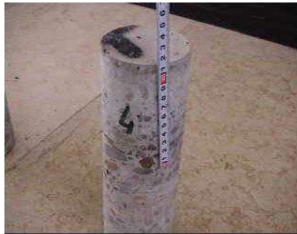
الشكل رقم (6): ارتفاع طبقة الحماية الخرسانية بمقدار 11\text{cm}
