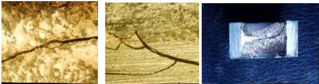
الشكل (6): العينة تظهر التشقق والتخدد فيها نتيجة التآكل الجاف
