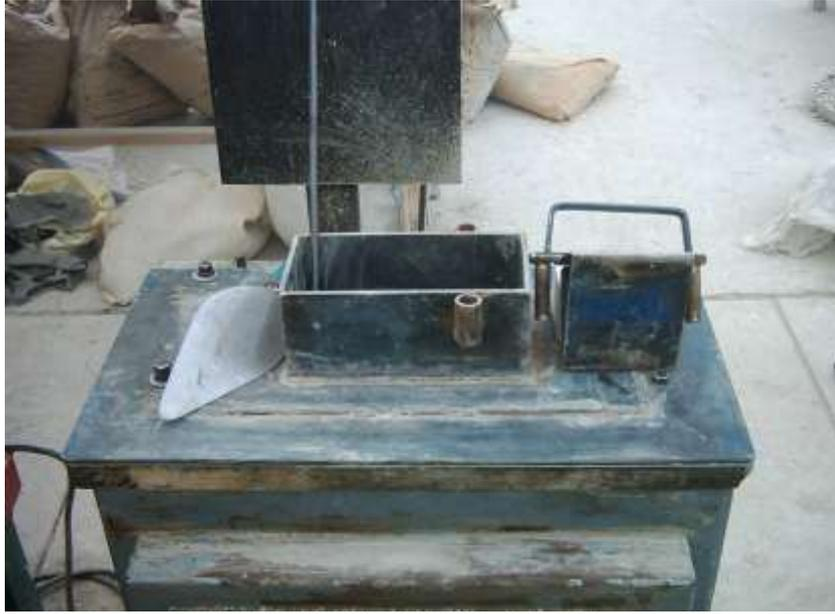
الشكل 2 : جهاز قياس قابلية تشغيل المونة (Maniabilimètre)
