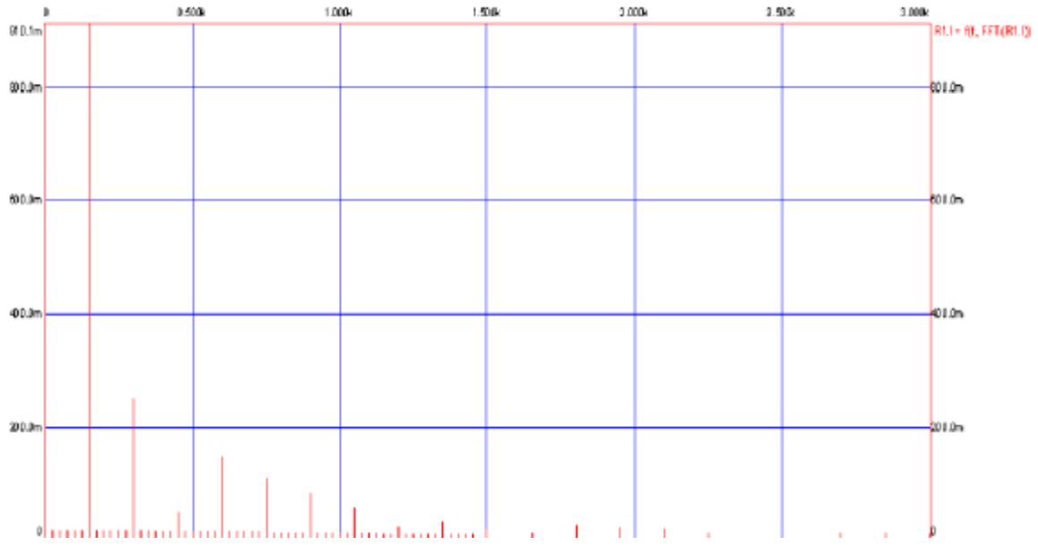
الشكل (7) يبين تحليل فورييه الطيفي لتيار الخرج للمقوم المقود قبل التعويض ( \gamma \neq 0 )
