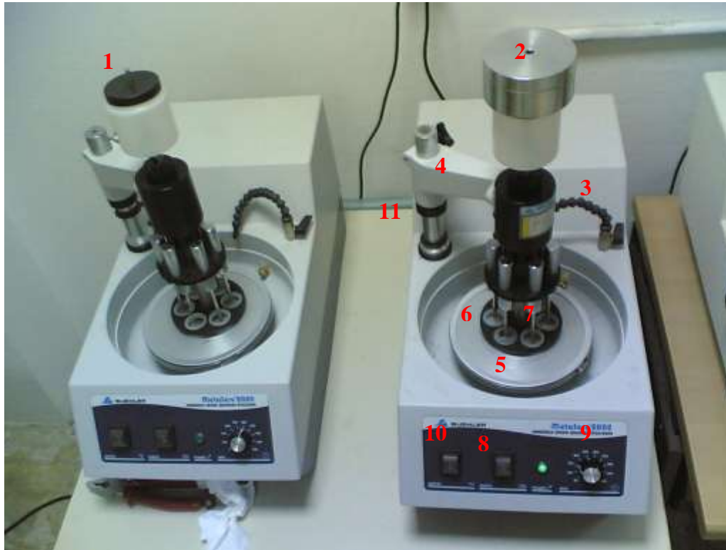
الشكل (2): جهاز الاختبار المستخدم (polishing machine)
