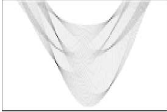
الشكل (6) المنحنيات الجيبية الناتجة بعد تطبيق تحويل هاف على صورة الشكل (5-b)
