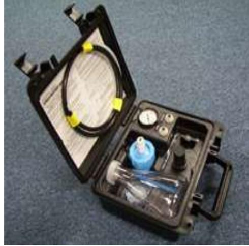
الشكل ( 2 ) جهاز قياس دليل كثافة الطمي المستخدمة في التجارب .
