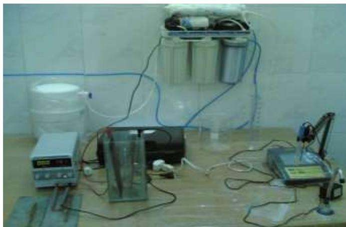
الشكل (4) وحدة التناضح العكسي مع المحول الكهربائي مع مفاعل التخثير الكهربائي.
