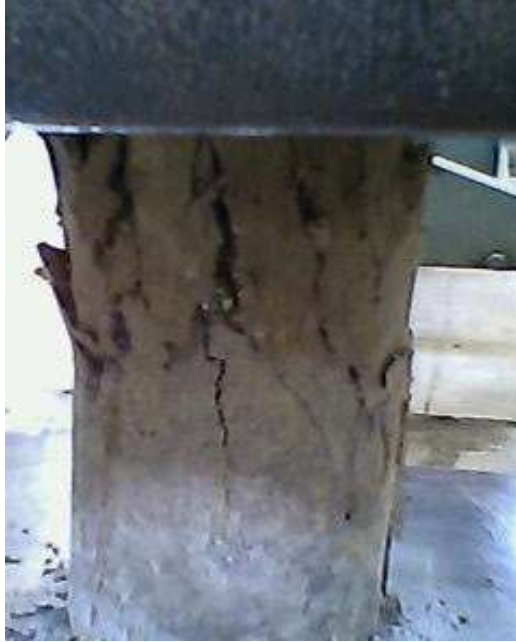
الشكل (4) عينة اسطوانية مسلحة بالألياف بعد إجراء تجربة الضغط عليها
