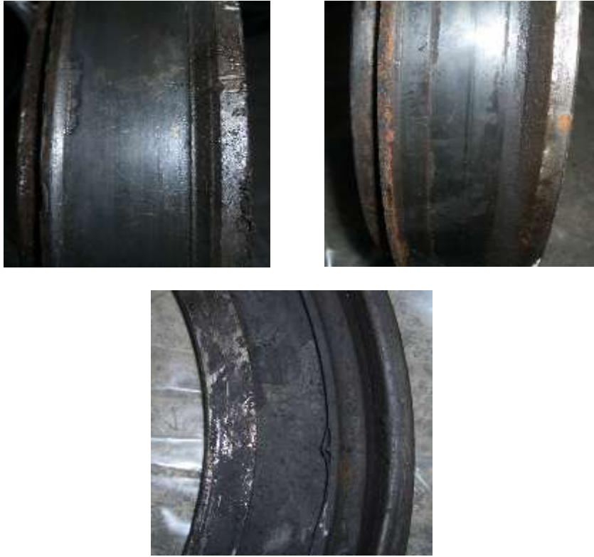
الشكل (10) بين أضرار الطبقة السيراميكية
