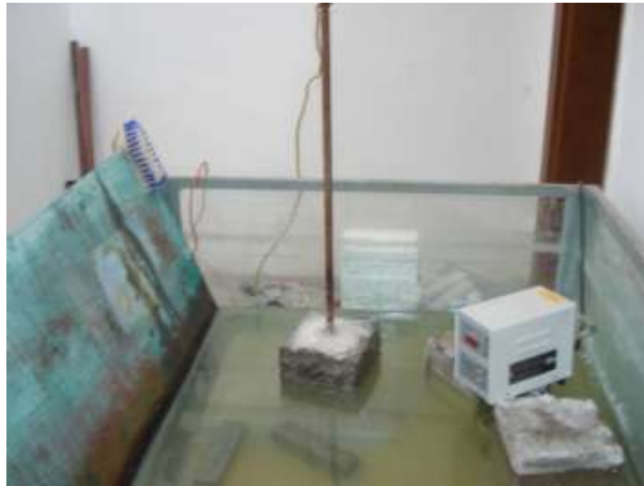
الشكل(9) صورة لنظام اختبار تآكل الفولاذ المسرع
