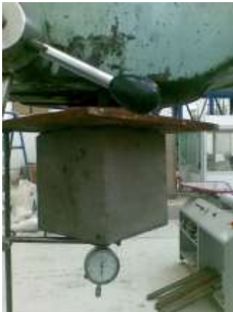
الشكل(12) صورة لنظام اختبار الشد
