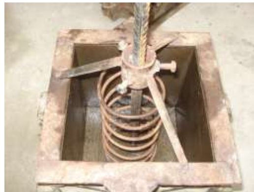
الشكل (7) تطويق وثبيت القضيب بشكل عمودي في المركز
