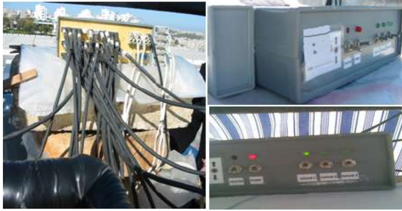
الشكل (9) واجهات مختلفة لمعالج المعطيات (Data Logger) المُصمم.
