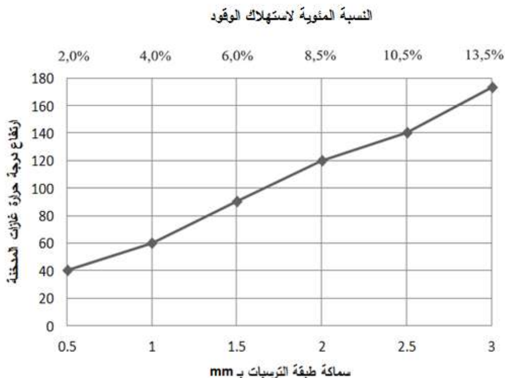
الشكل (4) يبين تغيرات استهلاك الفيول مع ثخانة الترسبات العازلة على سطح المبادل الحراري.
