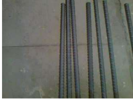
الشكل (4) القضبان الفولاذية المدهونة بالإيبوكسي
