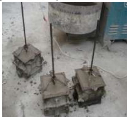
الشكل(3) يوضح شكل العينات البيتونية، وآلية تثبيت قضيب الفولاذ
