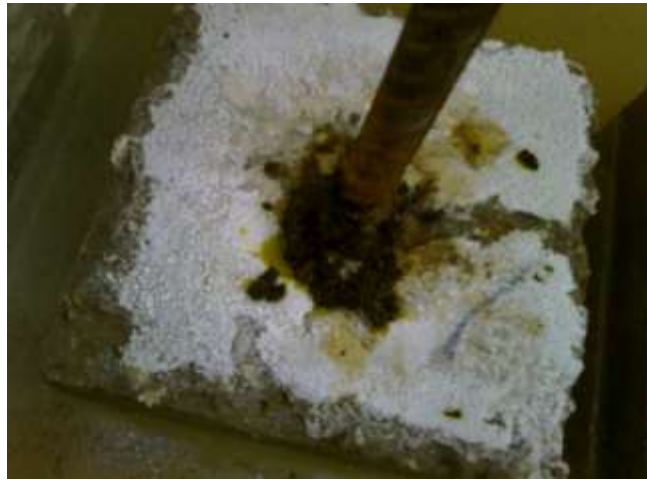
شكل (7) عينة من النموذج B بعد 240 ساعة
