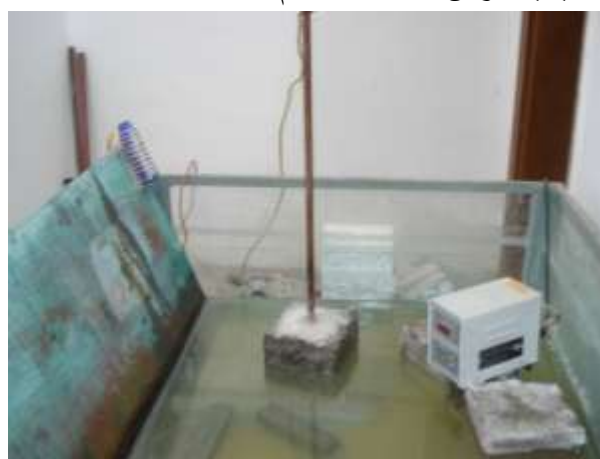
الشكل (5) يبين صورة فوتوغرافية وشكل تخطيطي لحوض التآكل المستخدم
