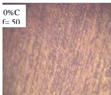
شكل (2): التآكل الالتصاقى خلال المرحلة الأولى لعينة الاختبار من UPE.
