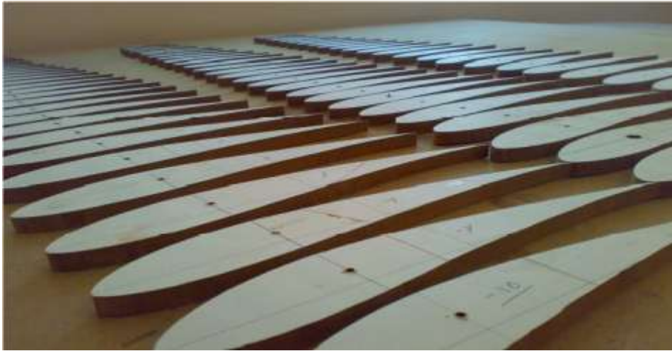
الشكل (12): عناصر الريشة المصنعة من ألواح الخشب المضغوط (MDF) بسماكة 1.4 سم
