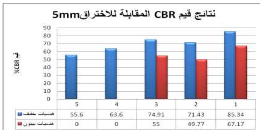
الشكل (11) : نتائج اختبارات CBR على ثلاث عينات هدميات خفاف وبيتون (اختراق 5)
