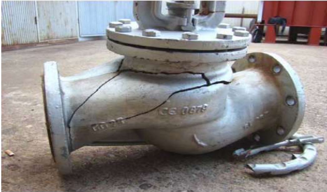
(الشكل 1) صورة تظهر حدوث تصدعات كبيرة وتحطم لصمام عدم الرجوع وذلك بسبب الضغوط الكبيرة
