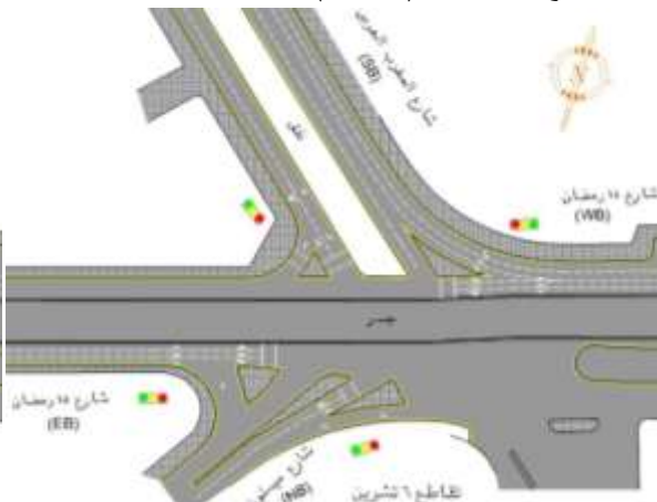
الشكل (4) حالة وجود حارة مشتركة (الحركة المستقيمة + حركة الانعطاف إلى اليسار) على كل من شارع 14 رمضان (WB) وشارع 14 رمضان (EB).
