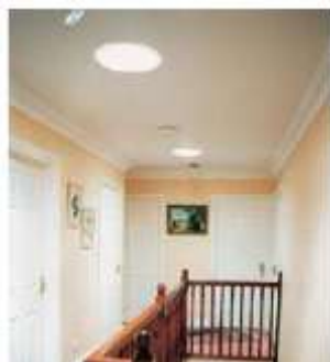
الشكل (6) يوضح توضع فتحات أنابيب الإضاءة في السقف
