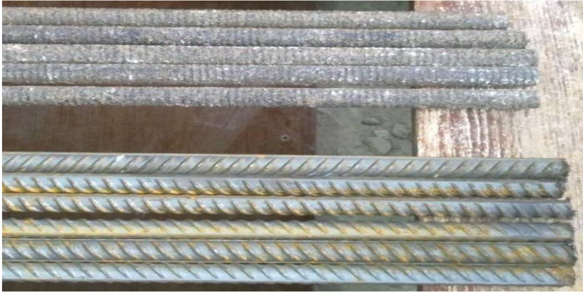
الشكل (1) شكل قضبان التسليح الكربونية CFRP والفولاذية المستخدمة في تسليح الجوائز المختبرة.
