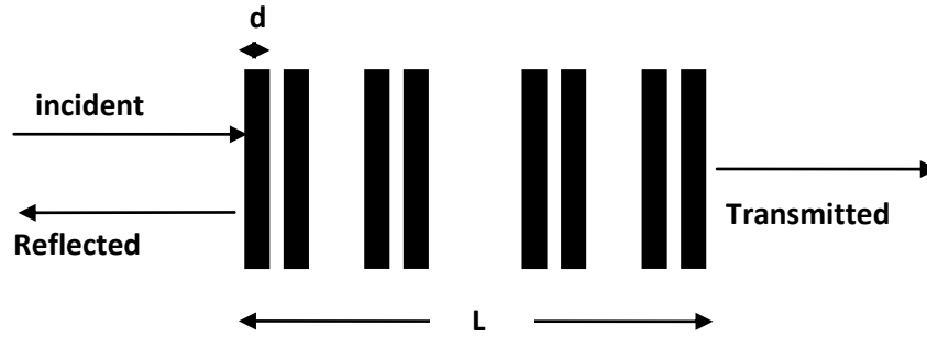
الشكل (2) ورود الأمواج بشكل ناظمي على شريط كانتور
