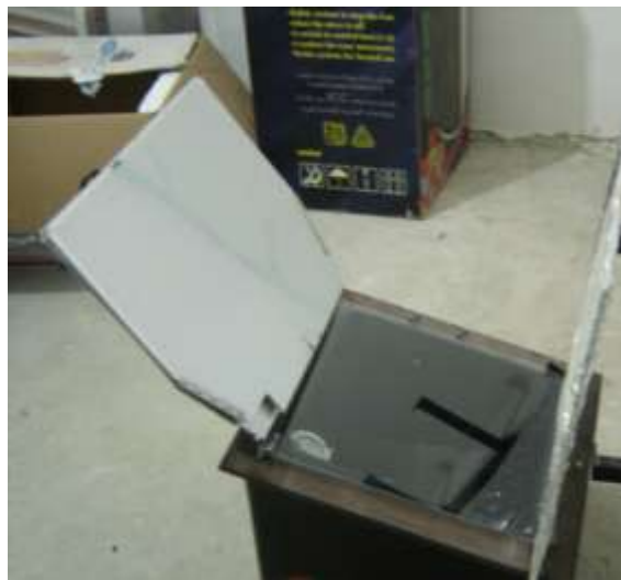
الشكل(11):صورة توضيحية للفرن الشمسي المجهز بعاكس ذي واجهة شمالية.
