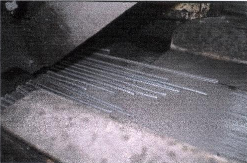
الشكل (5) صورة تبين عدم تساوي طول القضبان الحديدية و ذلك عند المقص النهائي.
