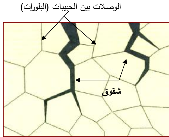
الشكل رقم (1) يظهر المسار الأكثر احتمالاً للشقوق التي يسببها هجوم الهيدروجين
