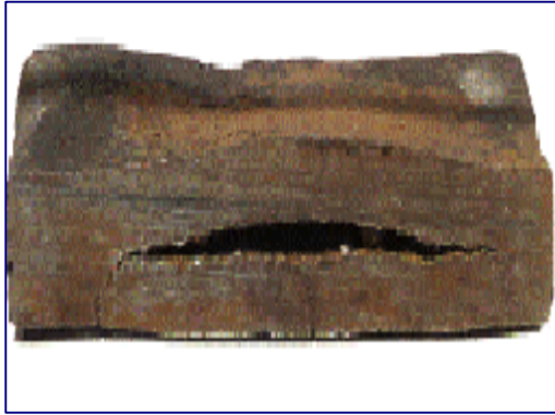
الشكل رقم (2) يظهر صورة لقطعة حديدية تعرضت لتقصف هيدروجيني من النوع (blistering) (12)
