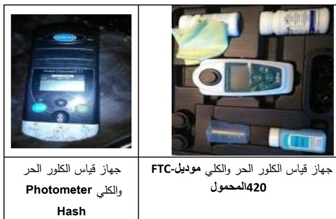
الشكل 4 جهازي الكلور الحر المستخدمين في القياس
