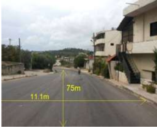
الشكل (4) منعطف أفقي بنصف قطر صغير مع منحني شاقولي مقعر لا تتحقق الرؤية والانسيابية
