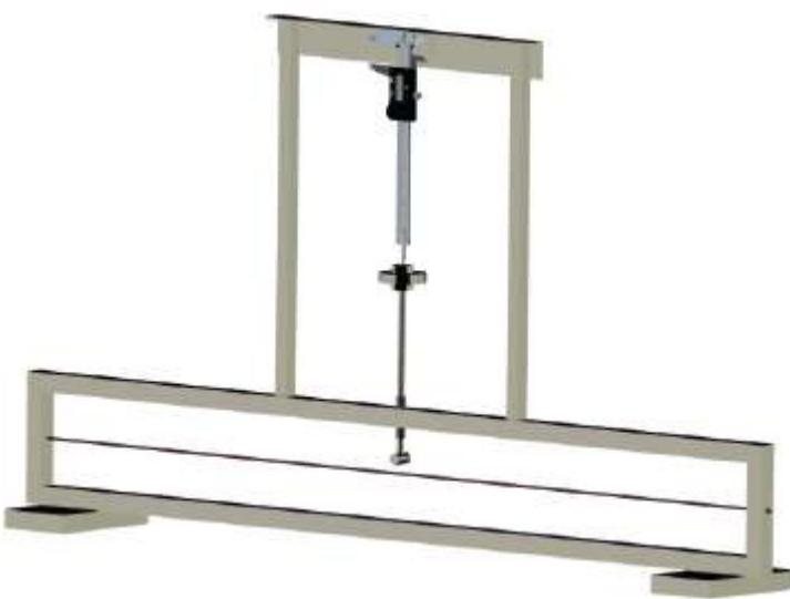
الشكل (3) نموذج CAD للجهاز لتحليل معامل المرونة
