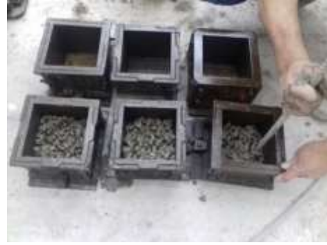
الشكل (11): دمك طبقات البيتون
