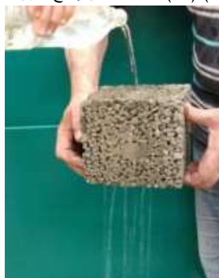
الشكل(20): مرور الماء عبر مكعب قياس 15*15*15 cm
