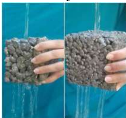
الشكل(21): مرور الماء عبر مكعبات قياس 10*10*10 cm و بأحجام مختلفة للحصىات
