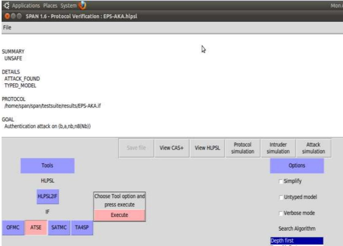
الشكل (4) اختبار البروتوكول EPS-AKA باستخدام SPAN
